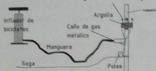
2. El agua se coloca antes de poner el cohete en el lanzador, y después rápidamente se coloca en el lanzador sin derramar el agua. Luego se sube la argolla para que la sujete la botella firmemente. Luego se procede a presurizar el cohete con el inflador hasta que no se pueda más y se tira de la cuerda para soltar el cohete que saldrá disparado.
